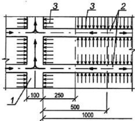
1 - вентилируемый канал; 2 - диффузионные каналы; 3 - движение влаги
