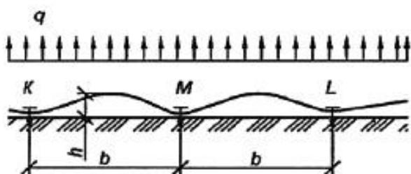
$b$  - ширина полотнищ рулонного материала;  $H$  - распор;  $h$  - высота подъема кровельного ковра;  $l_k$  - расстояние между крепежными элементами;  $N$  - продольное усилие;  $q$  - распределенная ветровая нагрузка, Н/м;  $C$ ,  $K$ ,  $L$ ,  $M$ ,  $O$  - точки
